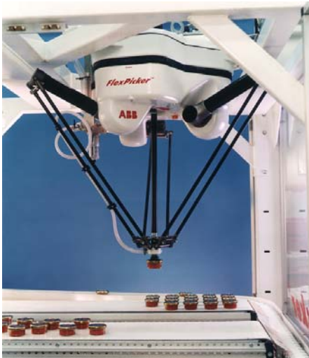
Figur 14. Ett exempel på en robot som har parallell kinematik. Roboten utnyttjas för plockning, paketering etc. Cykeltiden för att plocka, förflytta samt lämna en detalj är 0.45 s, vid lyfthöjden 25 mm och förflyttningsavståndet 305 mm (ref. ABB).
