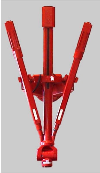
Figur 13. Ett exempel på en robot som har parallell kinematik för huvudrörelsen. Handleden har seriell kinematik. Robottypen utnyttjas för bearbetning och montering. (ref NEOS Robotics)
